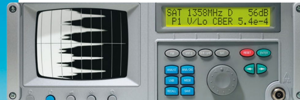
Die hochauflösende s/w-Bildröhre (5.5") für optimale Bildarstellung. Abbildung: schmalbandiges Spektrum SAT.
